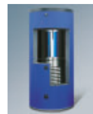
Solarspeicher Schnittmodell eines Tank-in-Tank-Speichers, innen Trinkwasser, außen Heizungswasser
